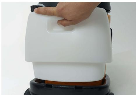
6. Remova o recipiente de água limpa da base do produto, abasteça-o com água limpa livre de resíduos sólidos e em seguida adicione a solução de limpeza seguindo as instruções de diluição do fabricante.
