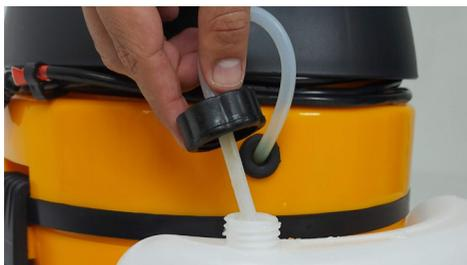
1. Para abrir o cabeçote e colocar os filtro para aspiração, desconecte a tampa de proteção da mangueira de sucção de água limpa.
