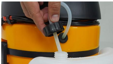
7. Coloque novamente a mangueira dentro do recipiente de água limpa e em seguida tampe-o.
