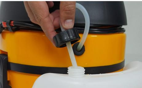
3. Para abrir o cabeçote, desconecte a tampa de proteção da mangueira de sucção de água limpa.
