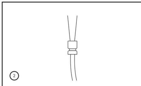
2. Segure a ponta com engate rápido para cima, abra a torneira até sair água, após 10 segundos feche o registro.
