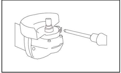
A capa de proteção permite diferentes posições de fixação. Fixe a capa de proteção de modo que as fagulhas produzidas não fiquem dispostas para o lado do operador. Utilize uma chave Philips (não fornecida) para fixá-la
