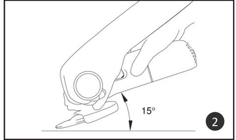
Para realizar o trabalho de corte ou desbaste, mantenha as mãos nos locais indicados para garantir a firmeza da ferramenta. Verifique que a ferramenta esteja posicionada de modo que o disco abrasivo não fique na mesma linha do operador (Figura 1). Para trabalhos de desbaste, mantenha o ângulo da ferramenta em  $15^\circ$  (Figura 2).
