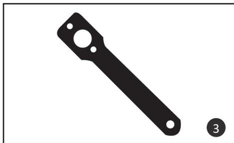
Para fixar o disco utilize a chave (3) fornecida com a ferramenta. Trave o eixo conforme figura (1), com o auxílio da chave de aperto da porca do disco (3). Aperte a porca no eixo até travar, figura (2).
