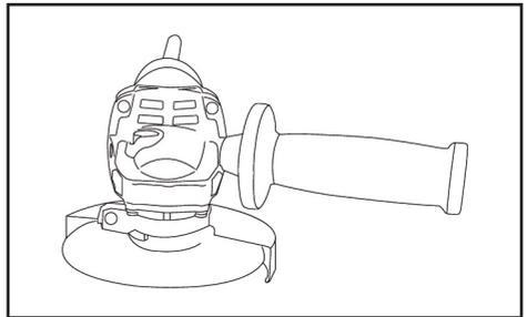
A utilização do punho aumenta a segurança do operador com a ferramenta. Este equipamento pode ser usado em diferentes posições para realizar os trabalhos.
