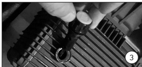
3. Retire a vareta de nível de óleo que é fornecida juntamente com o manual de instruções e instalar na bomba.
