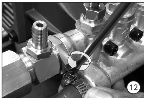
12. Encaixar a mangueira de alimentação de água na conexão da máquina, em seguida utilizar a abraçadeira fornecida para realizar a fixação.
