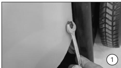
1. Remover os parafusos laterais do capô com o auxílio de uma chave de boca.
