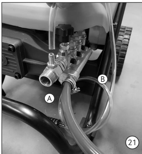
21. Encaixe a mangueira dreno de alívio no conector (A) e em seguida insira o filtro de água (B) em um ralo ou recipiente para o escoamento da água.
