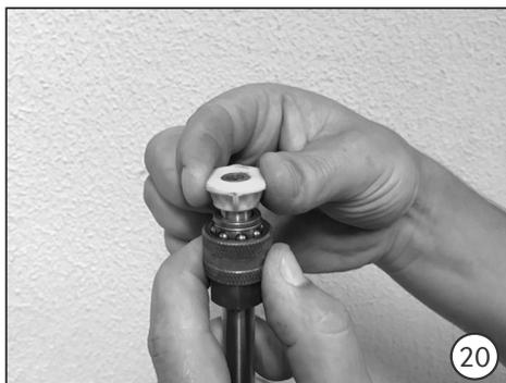
20. Escolha o bico específico para uso. Engate o bico puxando o engate rápido da lança e certifique se ele está corretamente conectado.
