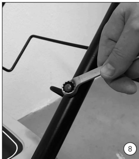
8. Fixe a porca cega M8 utilizando uma chave de boca conforme ilustrado.
