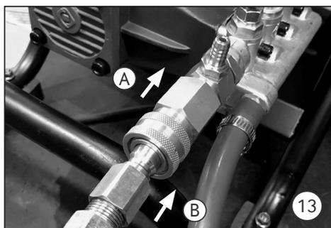
13. Empurre a trava do engate rápido (A) e conecte a mangueira de alta pressão (B) na saída de água.
