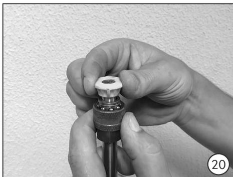
20. Escolha o bico específico para uso. Engate o bico puxando o engate rápido da lança e certifique-se de que ele está corretamente conectado.
