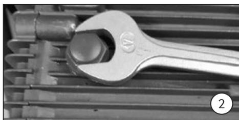
2. Com o auxílio de uma chave de boca, remover o tampão vermelho que está instalado na bomba.
