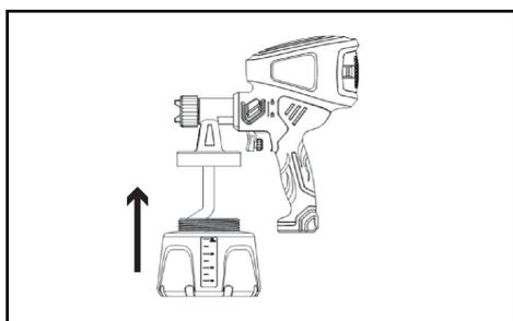
Conecte o recipiente de tinta no conjunto pistola, colocar o motor na parte superior do copo.
