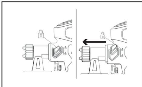
Desconecte a pistola para realizar a limpeza, deslocando o botão para cima para destravar.
