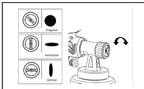
Ajuste o padrão do leque, conforme a figura.
