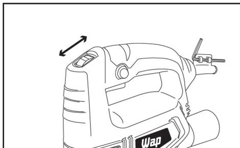
Para o ajuste de velocidade de golpes, gire o botão até a posição desejada, são 06 níveis de velocidade para realizar o trabalho de corte. Recomendamos realizar testes práticos para determinar a velocidade de golpes para determinados materiais.
