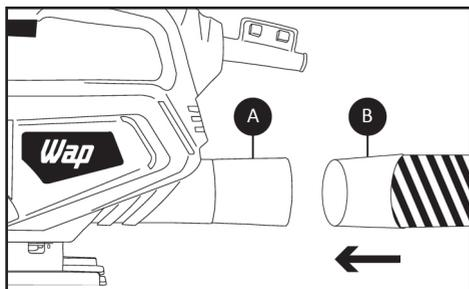
Para a utilização da Serra Tico Tico com o aspirador de pó, insira a mangueira do aspirador (B) no bocal da ferramenta (A).
