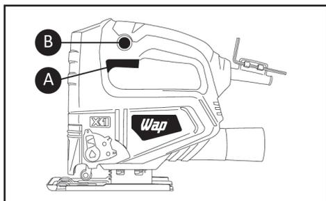
Pressionando o interruptor a ferramenta liga (A). Ao pressionar o nível máximo do interruptor (A), pode manter a ferramenta com funcionamento permanente, basta pressionar o botão trava (B). Para interromper o modo permanente é necessário pressionar o interruptor LIGA / DESLIGA novamente (A).
