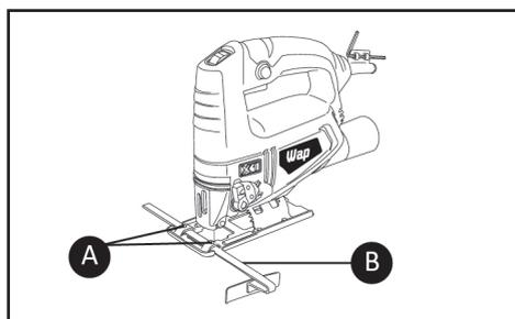
Utilize a guia de corte (B) para realizar cortes longitudinais. Escolha a distância pretendida do corte, em seguida aperte os parafusos de fixação da guia (A).
