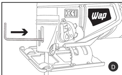
Retire a chave Allen do seu suporte (A), escolha a serra correta para o trabalho, insira a serra na ferramenta (B) conforme figura (C), em seguida com o auxílio da chave Allen, aperte os parafusos figura (D).
