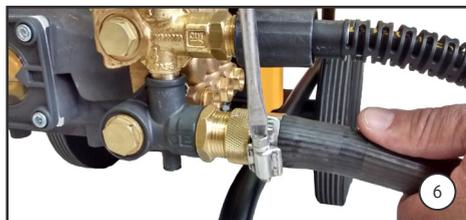
6. Em seguida conecte a mangueira de alimentação no espigão da entrada de água e fixe-a com uma abraçadeira.
