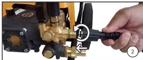
2. Conecte a mangueira de alta pressão na saída de água e gire a manopla até travar.
