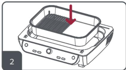
2. Para instalar a chapa posicione-a na frente da base para que ela se encaixe, então posicione a chapa até encaixar no lugar correto.
