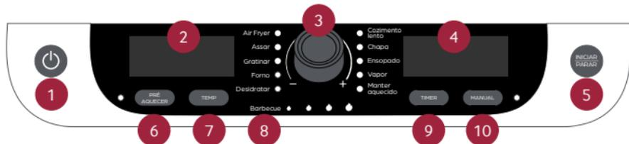
**1 – Botão LIGA/DESLIGA:** Quando a unidade estiver no modo de espera, pressione o botão liga/desliga para ligar a unidade, as luzes do botão liga / desliga e o display acenderão. Pressioná-lo durante o cozimento interrompe a função de cozimento atual e desliga a unidade.
