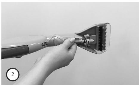
2. Conecte a mangueira de água/solução no bico extrator pequeno. Para fixar, insira o conector e gire 90° no sentido horário. Para desconectar, gire 90° no sentido anti-horário e remova.
