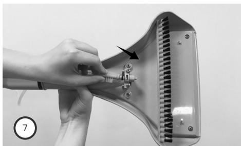
7. Conecte a mangueira de água limpa/solução no bico extrator grande. Para fixar, insira o conector e gire 90° no sentido horário. Para desconectar, gire 90° no sentido anti-horário e remova.
