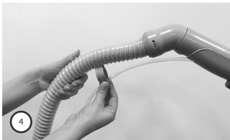
4. Fixe a mangueira de borrfir na mangueira de aspiração usando três dos cliques de fixação.
