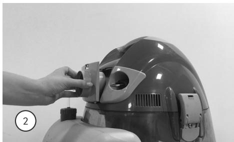
2. Coloque o adaptador do bocal de sopra.
