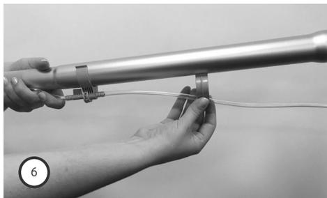
6. Prenda a mangueira transparente na extensão telescópica usando 2 abraçadeiras de fixação.
