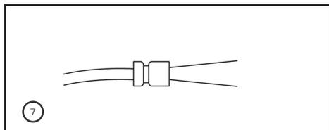
7. Segure a ponta da mangueira com engate rápido virado para cima, abra a torneira até sair água, após 10 segundos feche o registro.
