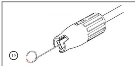
19. Se o bico da pistola estiver obstruído, fará com que a pressão da máquina aumente, a válvula de segurança seja acionada, e posteriormente a máquina desligará automaticamente. Você deverá realizar a limpeza do bico de alta pressão com o auxílio de uma agulha que acompanha o produto.
