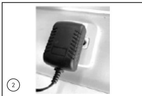
2. Quando o carregador for conectado à energia elétrica, deverá acender um LED indicativo verde indicando que o carregador está funcionando. Caso o LED indicativo de funcionamento não for aceso, verifique na Tabela de Causas e Soluções de Problemas no final deste Manual de Instruções como proceder.
