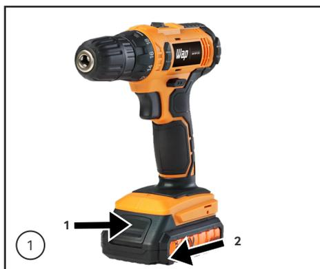
1. Remova a bateria da ferramenta, pressione o botão de liberação (1) e ao mesmo tempo desconecte a bateria movendo para frente (2).
