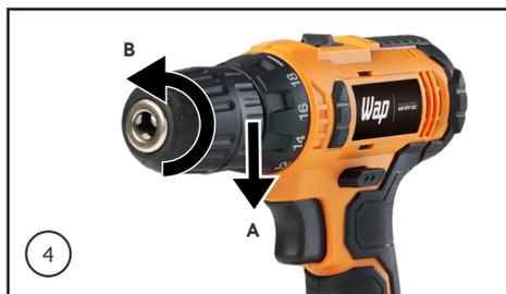
4. Para abrir a castanha do mandril, segure a parte A e gire no sentido anti-horário a parte B até obter a abertura necessária para o encaixe do acessório que será utilizado.
