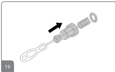
**19.** Remova o filtro de dentro da entrada de água e limpe-o em água corrente, em seguida remova o conector da entrada de água e limpe-o em água corrente.
