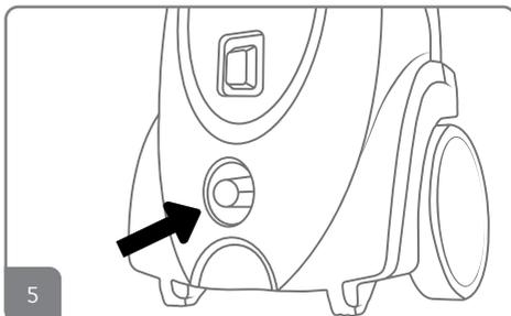
5. Conecte o espigão na conexão de entrada de água, conforme indicado.
