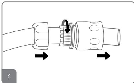
**6.** Solte a arruela do engate rápido e encaixe a coroa na mangueira de alimentação. Depois, rosqueie o conjunto. Em seguida, engate a mangueira de alimentação em sua rede de água.
