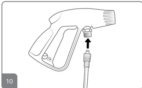
**10.** Para fixar a outra extremidade da mangueira de alta pressão na pistola, basta conectá-la completamente, como indicado na imagem, e depois rosquear. Para remover, basta desrosquear e em seguida, puxar o conector.
