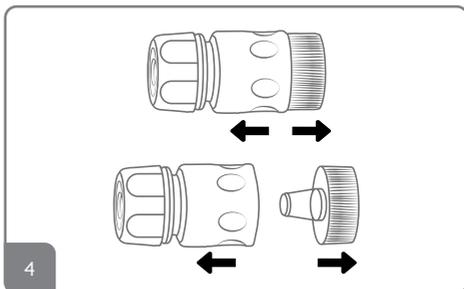
4. Com o espigão em mãos, destrave-o do engate rápido, pressionando a parte móvel no sentido da seta. Em seguida, separe o espigão do engate rápido.
