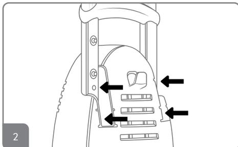
2. Parafuse a alça com os quatro parafusos que acompanham o produto, conforme a indicação.
