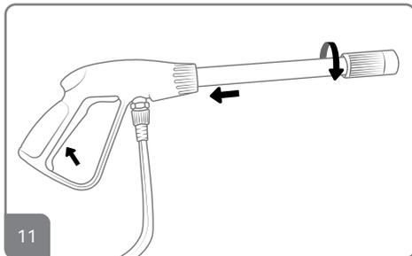
**11.** Após instalar a máquina corretamente, ligue apenas a alimentação de água. Em seguida, conecte a baioneta na pistola pressionando e girando meia volta até travar. Seguidamente, segure o gatilho da pistola por aproximadamente um minuto até que o fluxo de água se estabilize.
