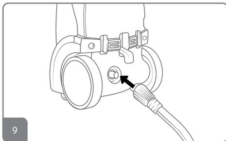
**9.** Para conectar a mangueira de alta pressão basta inseri-lá na saída de água, na parte de trás da lavadora, e seguidamente rosqueia-lá
