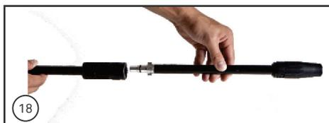
18. Solte o gatilho e desconecte a lança com bico regulável da baioneta, pressionando e girando meia volta até soltar.
