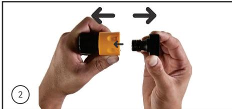
2. Destrave o espigão do engate rápido, pressionando a parte móvel no sentido da seta existente no mesmo e retire o espigão do engate rápido, separando as duas peças.
