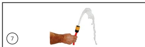
7. Conecte a mangueira de alimentação em sua rede de água. Segurando a ponta com o engate rápido para cima, abra a torneira até sair água (para retirar o ar).
