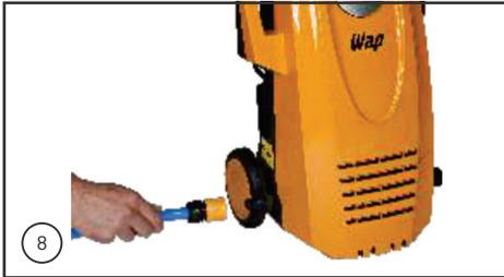
8. Em seguida, conecte o engate rápido ao espigão, sem deixar a água da mangueira retornar, para evitar a entrada de ar na mesma.
