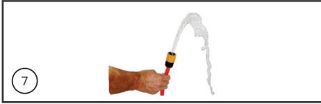
7. Conecte a mangueira de alimentação em sua rede de água. Segurando a ponta com o engate rápido para cima, abra a torneira até sair água (para retirar o ar).
