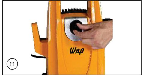
11. Ligue o equipamento posicionando o botão liga / desliga na posição ON.
