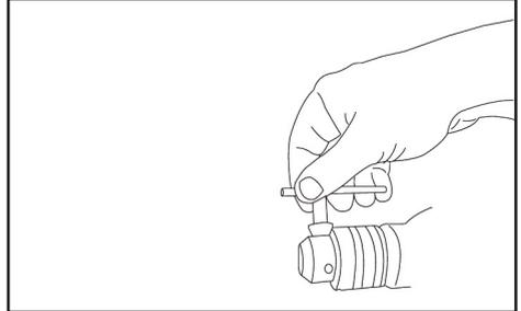
1. Com a chave de mandril inserida no orifício de fixação do mandril, gire-a no sentido anti-horário, com isso efetuando a abertura das castanhas do mandril.
