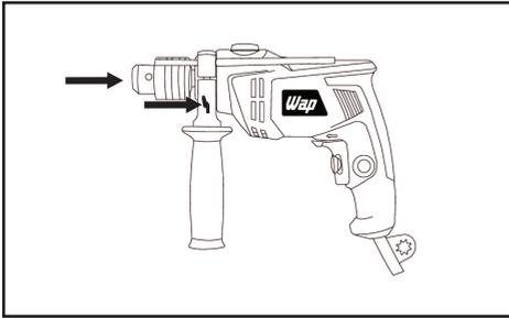
1. A utilização do punho auxiliar multidirecional aumenta a proteção do operador durante a utilização da ferramenta elétrica, além de lhe oferecer um maior conforto e estabilidade durante a operação de perfuração.
