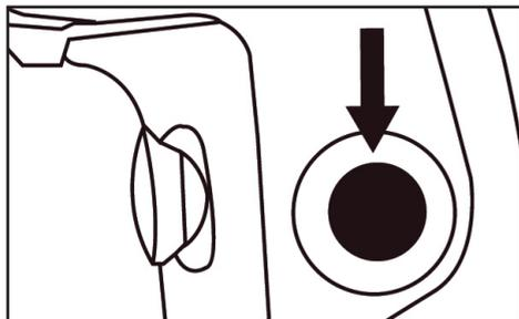
2. Em seguida pressione o botão trava ao mesmo tempo. Se precisar interromper o modo de funcionamento permanente, se faz necessário pressionar o interruptor liga / desliga novamente e soltar, com isso a trava de trabalho contínuo será desativada.
