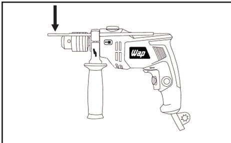
1. A utilização do limitador de profundidade se dá quando a perfuração requer uma padronização da profundidade dos furos. Você poderá mover a régua manualmente conforme a profundidade milimetrada na régua que desejar, apenas pressionando o botão lateral no punho auxiliar.
