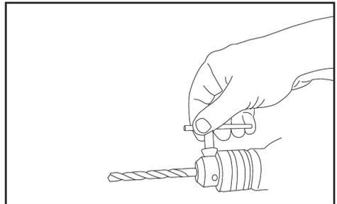
3. Insira novamente a chave de mandril no orifício de fixação do mandril e agora gire-a no sentido horário para concluir a fixação do acessório na ferramenta. Repita o processo inverso para remover o acessório utilizado no mandril.
