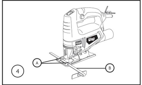
4. Coloque a guia de corte (B) para realizar cortes longitudinais. Escolha a distância pretendida do corte, em seguida aperte os parafusos de fixação da guia (A).
