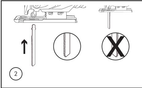
2. Escolha a serra correta para o trabalho, após isso insira a serra no produto conforme figura acima. Lembre-se de posicioná-la da forma correta com a lamina de corte para frente.
