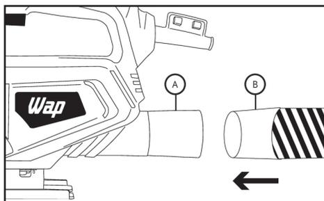
5. Para a utilização da Serra Tico Tico com o aspirador de pó, insira a mangueira do aspirador (B) no bocal da ferramenta (A).
