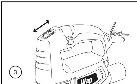
3. Para o ajuste de velocidade de golpes, gire o botão até a posição desejada, são cinco níveis de velocidade para realizar o trabalho de corte. Recomendamos realizar testes práticos para determinar a velocidade de golpes para determinados materiais.
