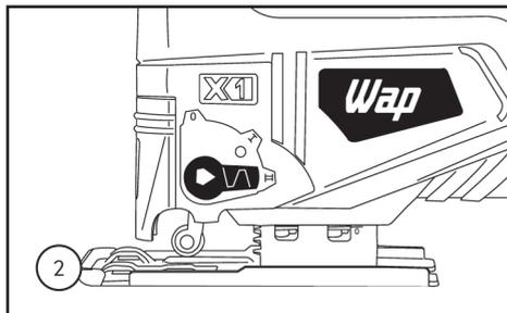
2. O ajuste permite duas regulagens. É indicado para cortes circulares.
