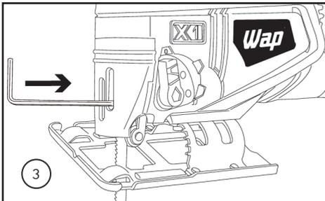
3. Com o auxílio da chave Allen, aperte os parafusos.
