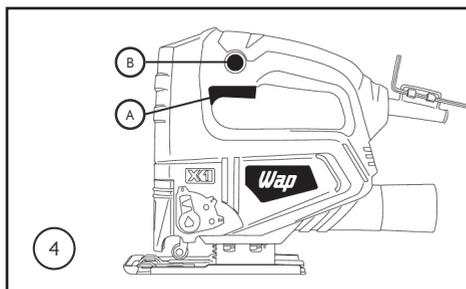
4. Pressionando o interruptor a ferramenta liga (A). Ao pressionar o nível máximo do interruptor (A), pode manter a ferramenta com funcionamento permanente, basta pressionar o botão trava (B). Para interromper o modo permanente é necessário pressionar o interruptor LIGAR / DESLIGAR novamente (A).
