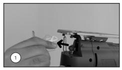
**1.** Remova a proteção plástica e posicione o produto adequadamente, para inserir a serra de corte.
