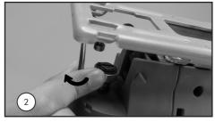
**2.** Para inserir a serra de corte, empurre a trava de engate rápido para frente.
