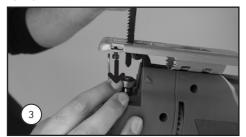
**3.** E encaixe a serra de corte com os dentes voltados para frente do suporte (sentido de corte).
