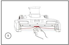
**6.** Remova as sujeiras no bocal de aspiração do acessório de piso com um pano úmido.
