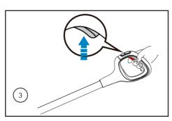
Para acionar o sistema de pulverização, pressione o gatilho conforme acima.
