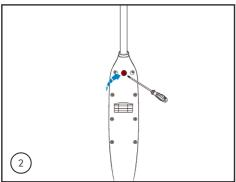
2. Caso necessitar desmontar a alça, com o auxílio de uma chave Philips remova o parafuso e pressione a mola no local para destravar a alça, em seguida remova-a.
