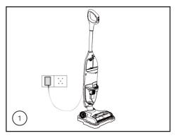
1. Encaixe o conector do carregador de bateria na unidade principal e o plugue na tomada elétrica. Antes do primeiro uso, carregue o seu produto por período mínimo de 5 horas.
