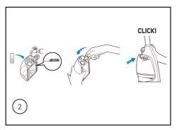
2. Despejar a solução de limpeza diluída seguindo as recomendações do fabricante e em seguida monte-o novamente repetindo o processo inverso. Aguarde o barulho de "Cilck" ao qual indicará que o recipiente (6) foi travado corretamente.
