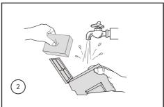
2. Abra a tampa do suporte do filtro e remova-o, lave-o sob água corrente. Deixe-o secar antes de realizar a montagem novamente.
