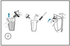
2. Remova a tampa do recipiente, despeje a água em um local adequado e lave-o em água corrente. Em seguida faça novamente a montagem no produto. Se necessário, utilize a escova de limpeza que acompanha seu produto para auxiliar na limpeza.
