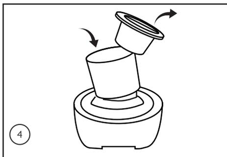
4. Retire a gaiola e coloque o filtro no local indicado. Instale novamente a gaiola no cabeçote colocando e girando no sentido anti-horário.
