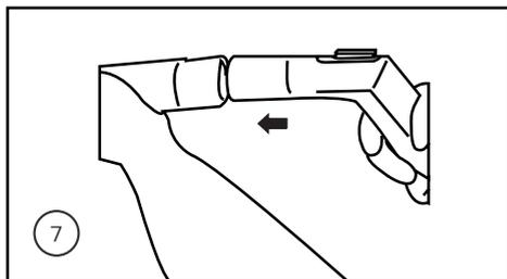
7. Conecte a extensão reta na extensão curva, e trave-a girando o pino parte inferior da extensão curva.
