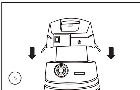
5. Com os filtros instalados, coloque o cabeçote novamente no recipiente e feche as travas laterais.
