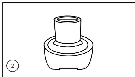
2. Verifique se o cabeçote está com o filtro permanente instalado.
