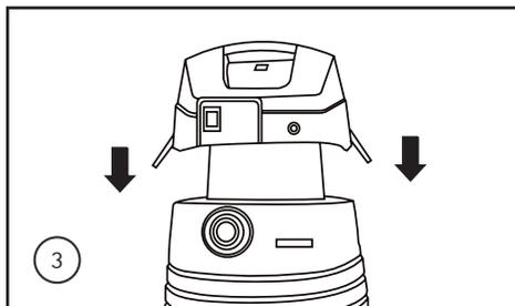
3. Com os filtros instalados, coloque o cabeçote novamente no recipiente e feche as travas laterais.
