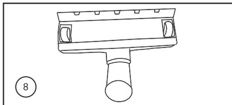
8. Encaixe o bico múltiplo na extensão reta e trave-a girando o pino na parte inferior da extensão reta. Ele é utilizado para limpar pisos laminados, azulejos, carpetes ou outros tipos de piso.
