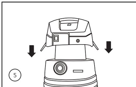
5. Com o filtro instalado, coloque o cabeçote novamente no recipiente e feche as travas laterais.
