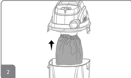
2. Após remover o cabeçote, pegue o filtro de pano e abra bem o elástico de fixação e posicione o filtro ao redor da gaiola da boia cobrindo todo e qualquer buraco (como indicado na imagem acima) prevenindo a entrada de sujeira no motor.
