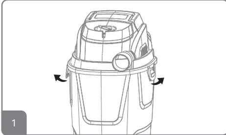
1. Abra as travas laterais do cabeçote, e retire todos os acessórios que estão dentro do barril para montar o aspirador.
