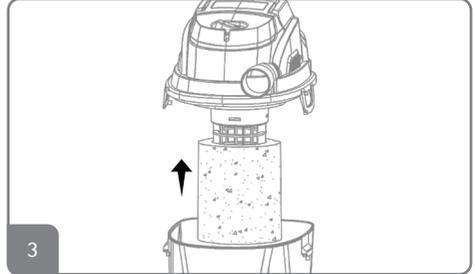
3. Após remover o cabeçote, pegue o filtro espuma e posicione o filtro ao redor da gaiola da boia cobrindo todo e qualquer buraco (como indicado na imagem acima) prevenindo a entrada de líquidos no motor.
