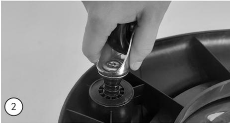
**03. ALÇA PARA TRANSPORTE:** Encaixe a alça no recipiente conforme a figura e com o auxílio de uma ferramenta parafuse a alça nos suportes do recipiente.
