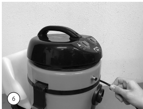
6. Engate a mangueira de água no conector do cabeçote.
