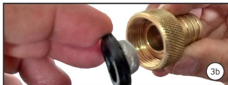
3. Periodicamente limpe o filtro da entrada de água, **(a)** para isto retire o espigão da entrada de água, **(b)** retire o filtro do espigão, lave-o em água corrente, reposicione o filtro e recoloque o espigão.
