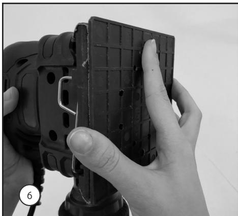
6. Com a lixa presa no produto, encaixe o gabarito na base da lixa, utilizando as abas laterais do gabarito como guia.
