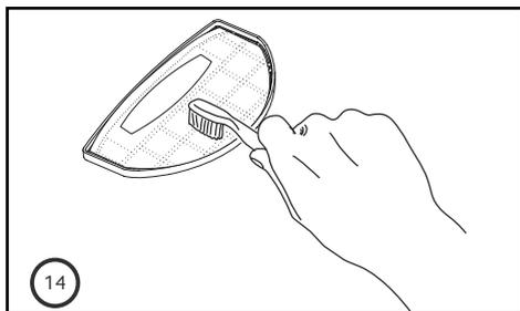
14. Em seguida, limpe-o sempre a cada utilização com o auxílio de uma escova com cerdas macias ou lavando em água corrente. Deixe-o secar em local arejado e só instale novamente quando ele estiver completamente seco.
