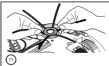
15. Remova a escova lateral puxando-a e destacando do aparelho.
