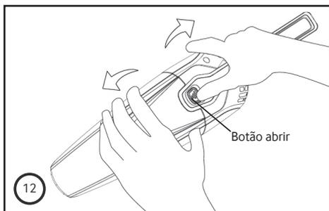
12. Para remover a sujeira do reservatório de poeira e do filtro, pressione o botão 'abrir' para destravar a parte de cima do recipiente, em seguida faça o movimento para baixo para destravar a parte de baixo do recipiente.
