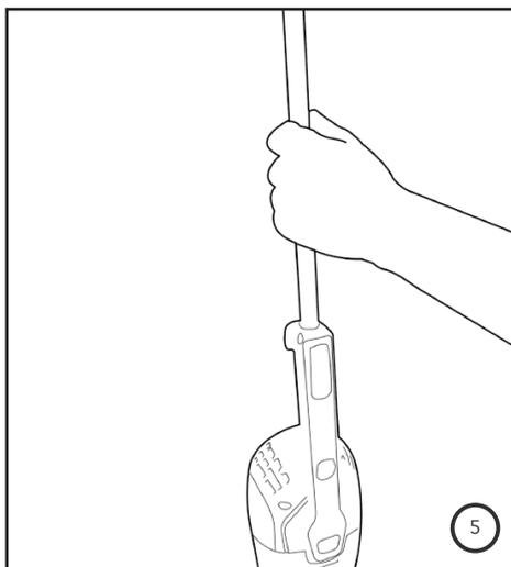
3. Empurre a haste até o final, de modo a garantir que a trava não permita que os componentes se soltem durante a utilização do produto. Plugue o cabo elétrico em uma tomada compatível com a tensão de seu aspirador, ligue-o e inicie o trabalho. Para remover a haste, pressione a trava com uma das mãos e, com a outra, puxe o componente para cima.
