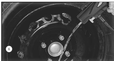
6. Antes de continuar a montagem, pressione o gatilho da pistola de alta pressão (sem extensão) para uma direção segura. Inicialmente o jato sairá inconstante, continue pressionando até que se forme um jato com fluxo contínuo como mostra a imagem (sem bolhas de ar).
