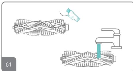
61. Limpe a tampa da escova rotativa com a escova de limpeza que acompanha o produto ou com um pano macio. Prossiga com a limpeza da escova rotativa, fios de cabelo e linhas de tecido ao qual podem estar enroscados nas cerdas de nylon, utilize a extremidade da ferramenta de limpeza para removê-los. Por fim, lave a escova rotativa em água corrente cuidadosamente a fim de evitar que ocorra deformações nas cerdas.
