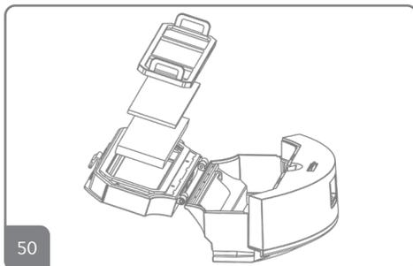
**50.** Abra a tampa superior manualmente e remova os filtros. Lave o recipiente de pó e água com água com a ferramenta de limpeza.
