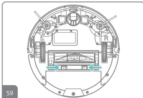
59. Para remover a escova rotativa pressione as duas travas e remova a tampa inferior.
