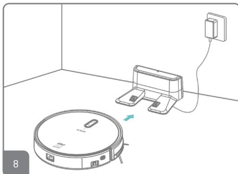
8. Posicione o robô alinhando os contatos de carregamento localizados na parte inferior do robô e na base. Quando o contato for bem-sucedido, o robô emitirá um aviso audível e os botões do robô acenderão.
