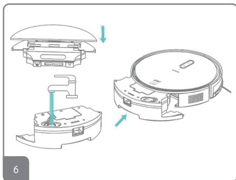
6. Instale o recipiente de água e pó colocando o MOP conforme a imagem. Abra o reservatório de água, encha-o com água e feche-o. Instale o recipiente de água e pó no robô e inicie a limpeza.
