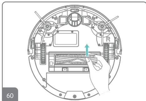
60. Puxe a alavanca que trava a escova rotativa e retire a escova puxando pelo lado cinza e limpe o bocal de sucção com um pano.
