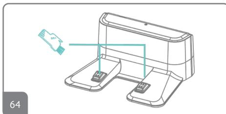
64. Limpe os contatos elétricos de carga na base de carregamento com a escova de limpeza ou pano macio periodicamente. Conforme utilizar seu aparelho, sujeiras podem ficar sobre estes e impactar no carregamento e na limpeza.
