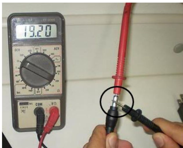
Imagem 4- Exemplificação de medição da saída do carregador.
