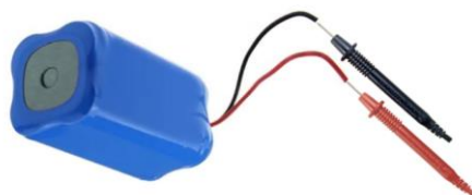
Imagem 3- Exemplificação de medição da tensão de bateria.
