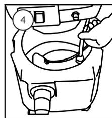
4. Ao colocar o cabeçote encaixe o bico de sucção dentro do recipiente de água limpa/sucção.
