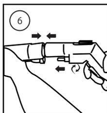
6. Conecte a extensão curva na extensão reta, e trave-a girando o pino parte inferior da extensão curva.
