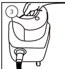
3. Retire o recipiente de água limpa/solução e enche-o com água limpa + solução anti-espumante, encaixe novamente no recipiente de água suja.
