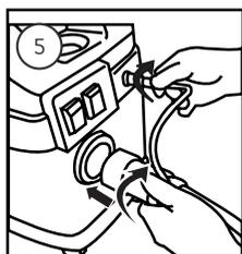
5. Encaixe a mangueira spray no cabeçote girando sentido horário até travar, coloque a mangueira de sucção no recipiente de água suja e trave.
