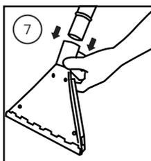
7. Encaixe a extensão reta no rodo para piso e trave-a girando o pino na parte inferior da extensão reta.
