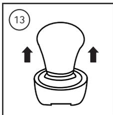
13. Retire o cabeçote e remova o filtro pano. Troque-o se necessário.
